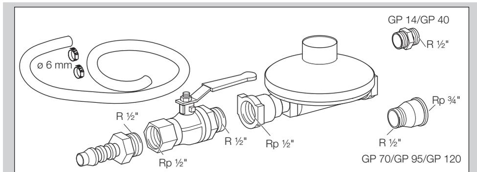
Réducteur de pression, robinet à boisseau sphérique, tuyau (longueur = 2 m), 2 colliers, double raccord R 1/2" pour GP 14/40, réduction R 1/2" – Rp 3/4" pour GP 70 – GP 120, pour le raccordement du bloc-combiné gaz CG à l'alimentation en gaz, n° réf. : N52600025
