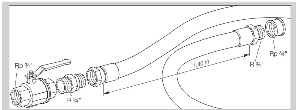
Kit de raccordement : raccord taraudé Rp 3/4", longueur totale = 1,50 m, n° réf. : N52600072
