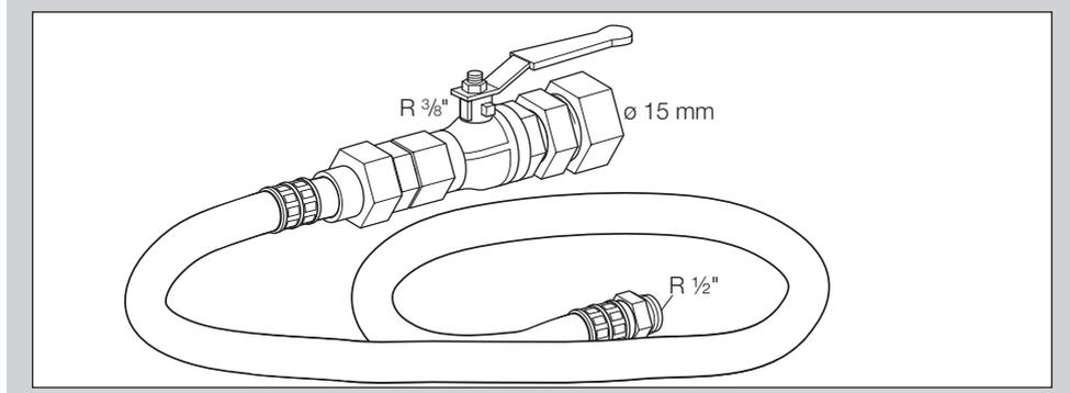
Robinet à boisseau sphérique et tuyau (certification DVGW, longueur = 2 m) pour le raccordement du bloc-combiné gaz CG à l'alimentation en gaz, n° réf. : N52990209
